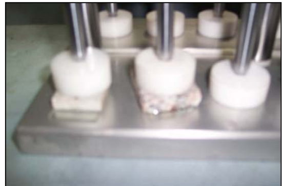
<본딩 지그(Bonding Jig, GLA-10)로 압착하면 기포 방지 및 수평작업이 됨>
