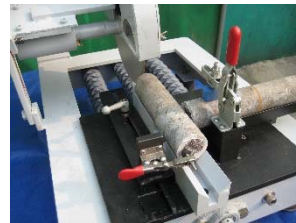
<NX Core 종/횡 방향 절단> <한국기초과학지원연구원 암석절단실>
