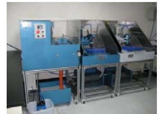
<NX Core 종/횡 방향 절단> <한국기초과학지원연구원 암석절단실>
