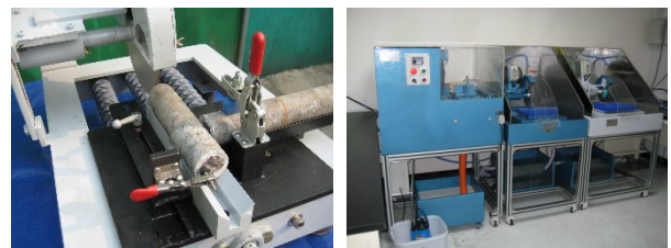
<NX Core 종/횡 방향 절단> <한국기초과학지원연구원 암석절단실>
